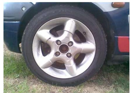
Bei Verwendung der vor genannten Felgen sind Sommerreifen der Dimension **185/50 R 14 77 V** zu verwenden. Es muss sich dabei um den **Profiltyp F109** der Marken **Rotalla, Tracmax, Tristar** oder **Minerva**, ... handeln. *(Diese Reifen sind ab ca. EUR 35,00 pro Stück erhältlich).*
